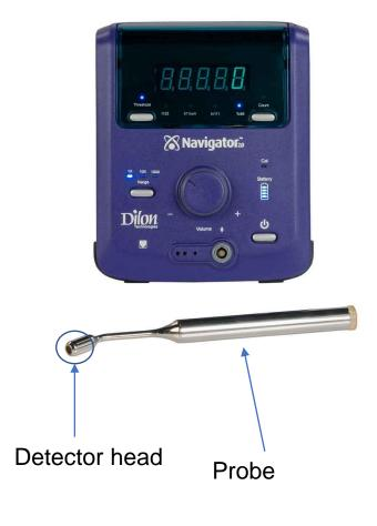
Fig. 3 Gamma Probe
